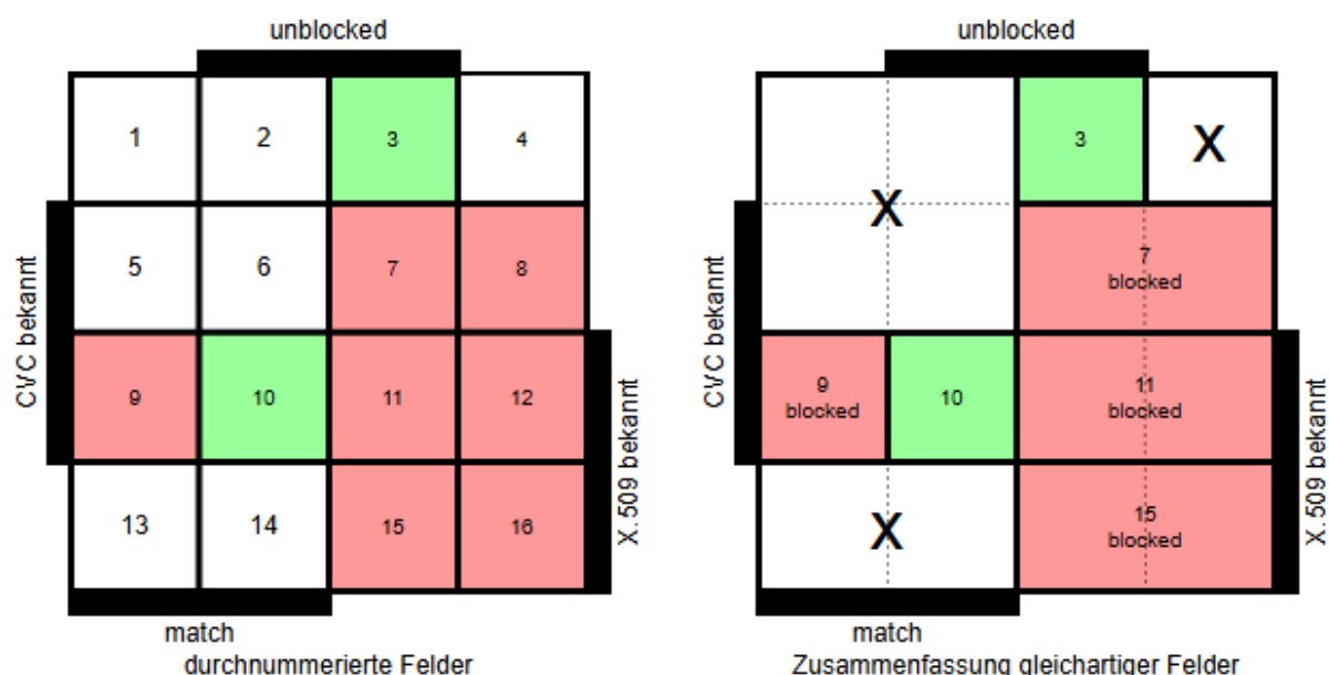
Abbildung 3 : Karnaugh-Veitch Diagramm zur "import"-Methode
